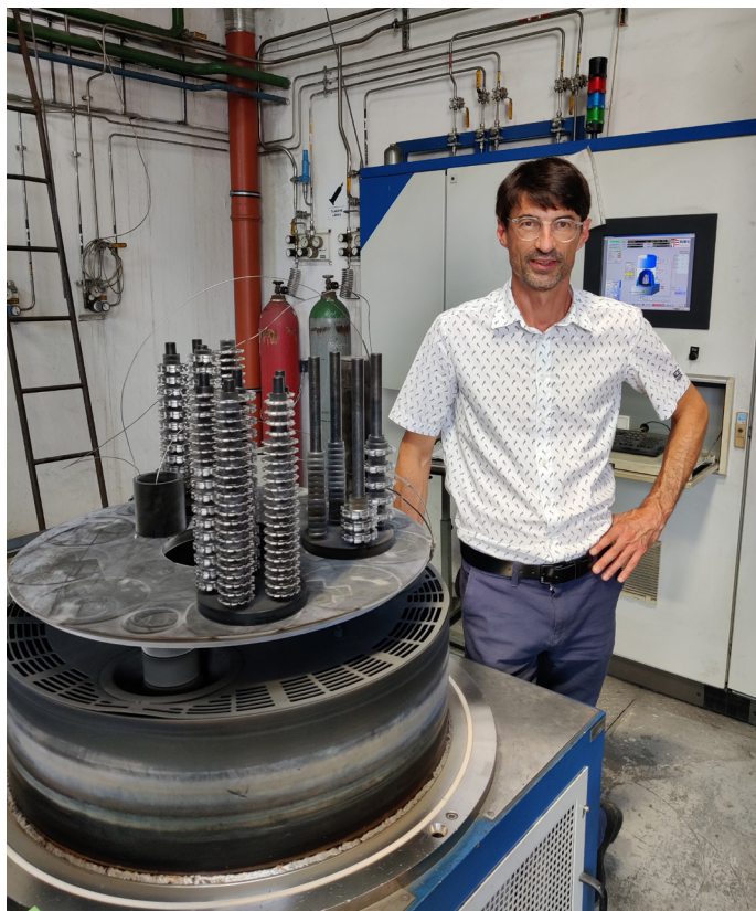
Saržovanie tvarových fréz – vakuumová nitridácia
